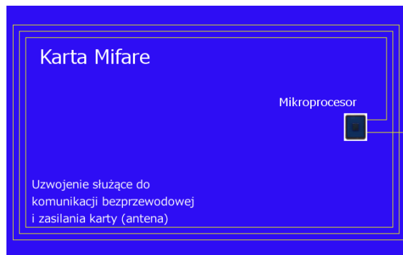
Rysunek 39. Fizyczna konstrukcja kart Mifare
