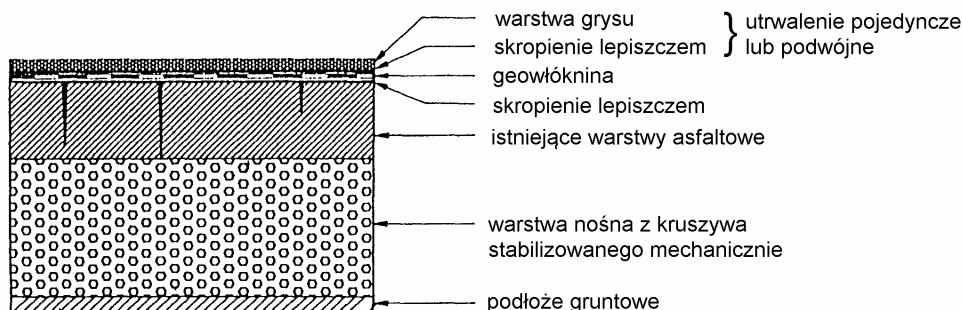
Rys. 1. Odnowa nawierzchni asfaltowej przez zastosowanie powierzchniowego utrwalenia
